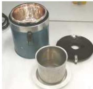
FIGURE 6.2 – Différents constituants d'un calorimètre.
